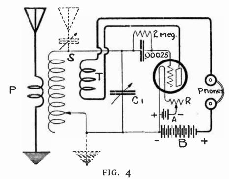
THE GRID LEAK AND CONDENSER
